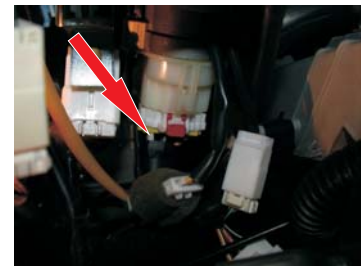
+50 На замке зажигания, БЕЛЫЙ провод
